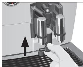
► Установите нижнюю часть системы приготовления молока снизу на уже вставленную часть.
