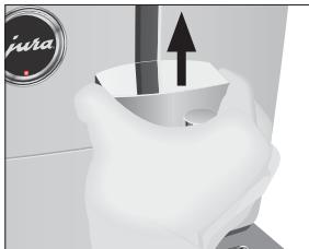
▶ Нажмите на деблокировочные элементы и снимите крышку комбинированного дозатора по направлению вверх.
